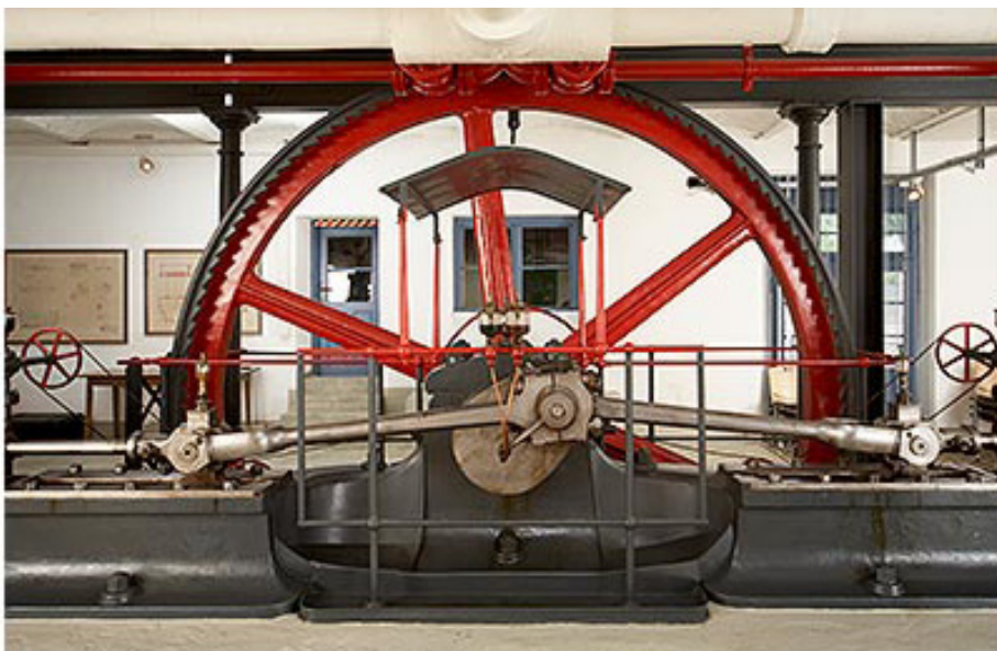
Die Linde'sche Eismaschine im Historischen Eiswerk der Paulaner Brauerei
